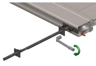
Mettez en place le prolongateur puis repositionnez les 2 vis à l'aide d'une clé de 10
