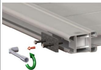
Retirez les 2 vis et la plaque de montage (les 2 vis serviront à l'étape suivante)
