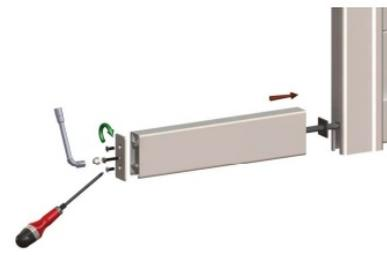
Insérez le support dans le prolongateur jusqu'au montant puis vissez l'embout à l'aide d'une clé de 10 et d'un tournevis cruciforme
