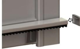
Insérez les embouts de finition
