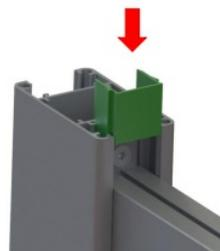
**Étape 10:** Mettez en place le profil U finition (coupé à la longueur de l'entre poteaux à l'aide d'une scie à métaux) et le collez avec des points silicone au dessus du profil Claustra
