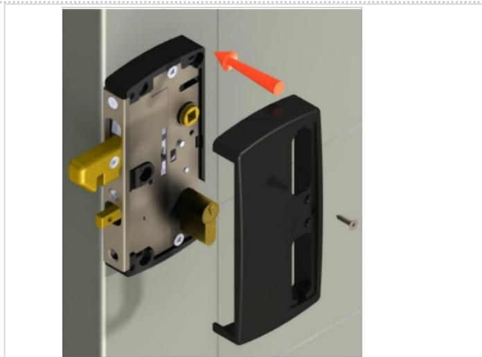
Étape 5 - Effectuez le serrage de la vis de maintien à l'aide d'un tournevis cruciforme
