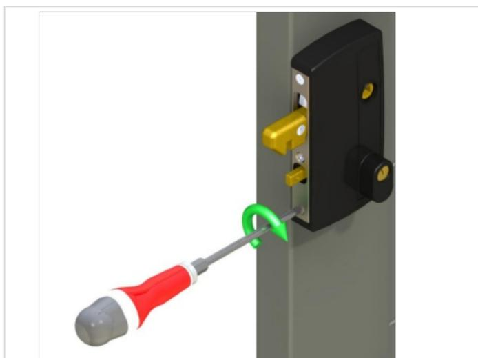
Étape 9 - Mettez en place la plaque de propreté (côté rue) puis effectuez le vissage à l'aide des 2 vis inox tête fraisée
