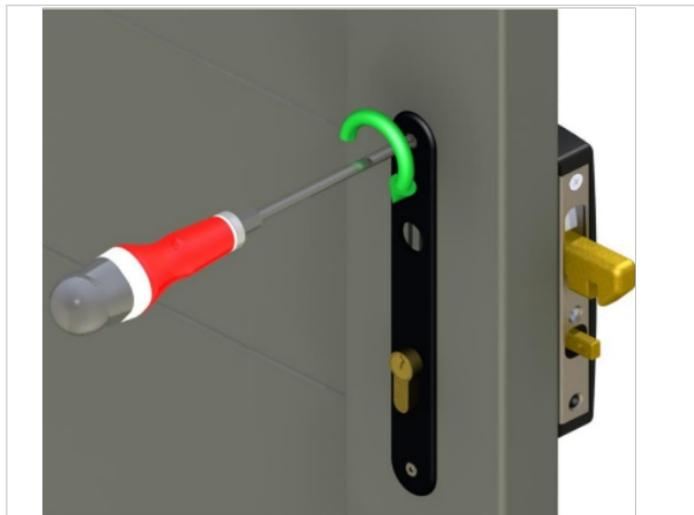
Étape 10 - A l'aide de la clé alène, effectuez le vissage de la béquille sur le carré inox puis insérez l'ensemble dans le montant et le bloc serrure
