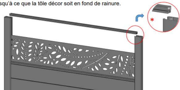
**Étape 5:** Faites glisser la première lame de la partie haute (\* lame tête en bas) jusqu'au profil jonc.
