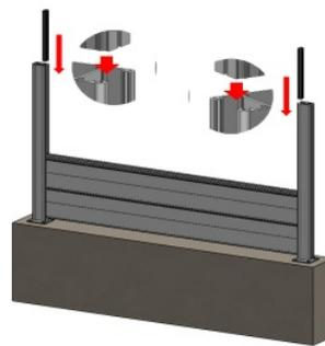
**Étape 3:** Faites glisser la tôle décor jusqu'au fond de la rainure du profil jonc.
