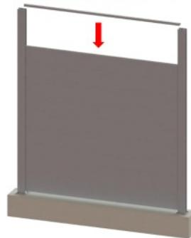
**Étape 3:** Faites glisser les deux closoirs tôle jusqu'au profil jonc
