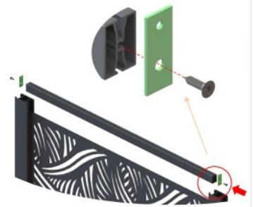
**Étape 6:** Faites glisser le profil claustra jusqu'à être en appui sur les closoirs tôle
