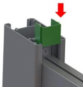
**Étape 9:** Mettez en place le profil U finition (coupé à la longueur de l'entre poteaux à l'aide d'une scie à métaux) et le coller avec des points silicone au dessus du profil Claustra
