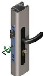
4• Introduire une clé aléne de 4 et tourner 3 tours dans le sens inverse des aiguilles d'une montre
