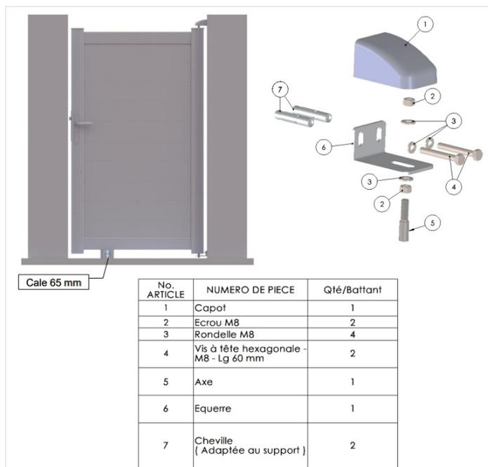
Étape 2 - Assemblez le gond sans le capot en veillant à assembler les rondelles dans le bon sens
