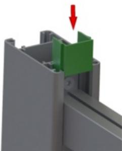
**Etape 19 :** Mettez en place le profil U finition (coupé à la longueur de l'entre poteaux à l'aide d'une scie à métaux) et le collez avec des points silicone au dessus du profil Claustra
